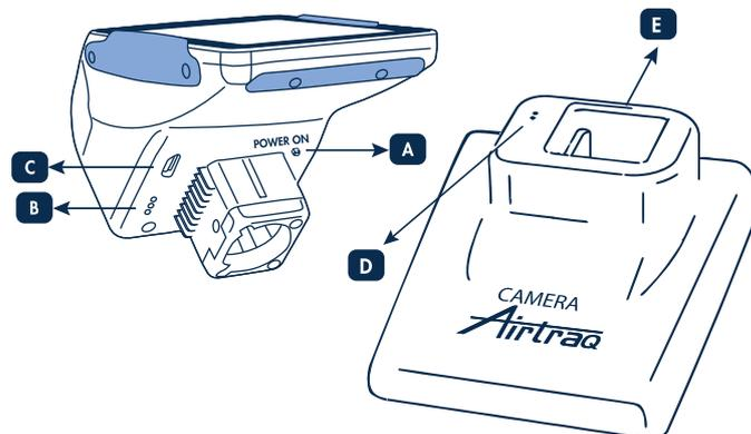
**A. Bouton d'alimentation automatique:** ce bouton est automatiquement enfoncé lorsque l'A-390 est insérée dans un Airtraq. Il peut également être pressé manuellement pour mettre l'A-390 sous tension. Pour mettre l'A-390 hors tension, appuyez sur l'icône correspondante du menu.
