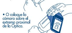
• Coloque el visor sobre el extremo proximal de la Óptica. Solo hay una posición en la que encaja.
