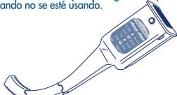
**La Pala:** Una pieza **DESECHABLE** de plástico rígido, de forma anatómica, que consta de dos canales laterales paralelos. Un canal, que termina en una lente distal, para la inserción de la Óptica, y otro canal, abierto en su extremo distal, que hace de guía para el tubo endotraqueal.
