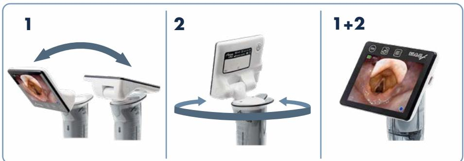
Das Symbol Drehen
